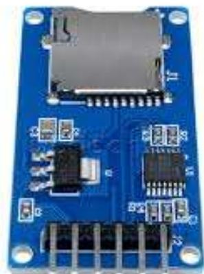
Рисунок 3.4. Загальний вигляд MicroSD Card Adapter
