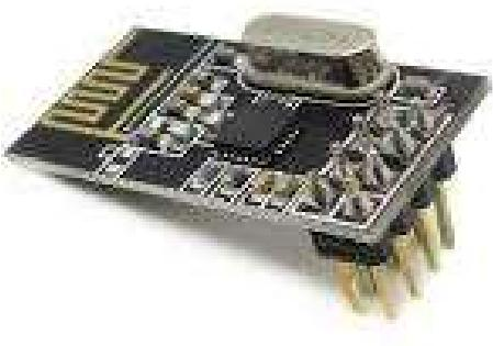
Рисунок 2.8. Загальний вигляд модуль радіо зв'язку NRF24L01+
