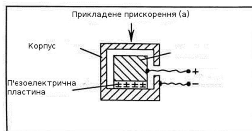
Рисунок 1.1 Принципова схема п'єзоелектричного акселерометра
