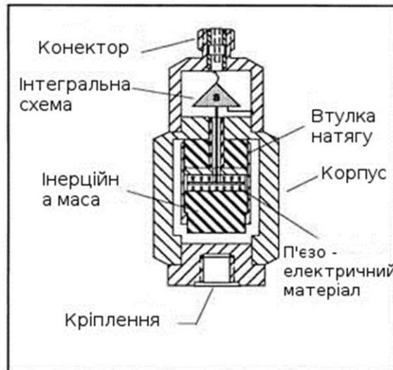
Рисунок 1.5 П'єзоакселерометр зворотного стиснення [18]
