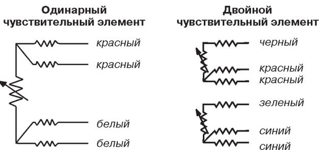
**TC Rosemount 0065 Клеммный блок - код выводов 2**
