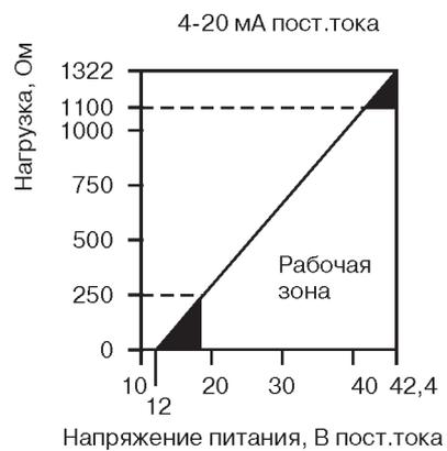
Рис.3. Ограничение нагрузки.
