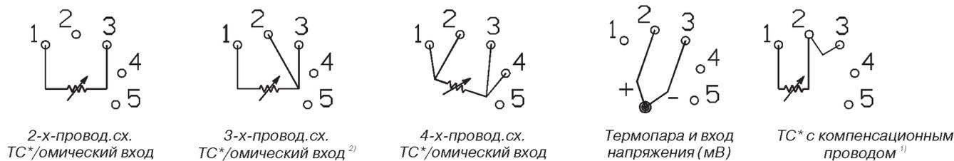
Рис.8. Схема подключения одинарного первичного преобразователя к Rosemount 3144P-HART/4-20 мА.
