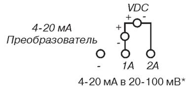
**Рис. 12. Схема подключения аналогового входа к преобразователю Rosemount 848T.**
